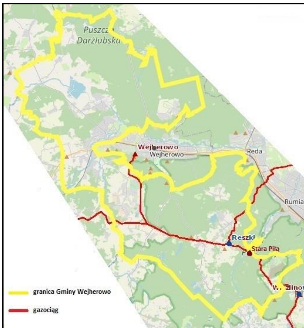
Rysunek 6. Schemat sieci gazowej wysokiego ciśnienia na terenie gminy Wejherowo
